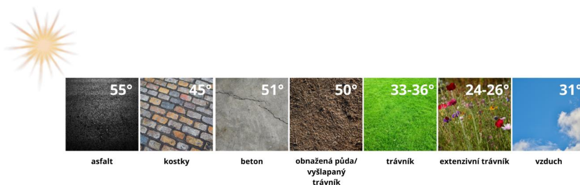
Obr. 8: Přibližné průměrné teploty povrchů na přímém slunci během letních veder (nad 30 °C). Přesnější teploty závisí na řadě faktorů, včetně délky vlny veder, venkovní teploty, větrné situaci atd.
